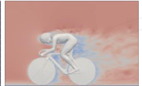
マルチキューブを適用した格子ボルツマン法(LMB)の解析例
